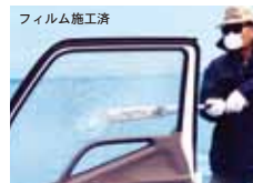
セキュリティフィルム窓に対する金属バット試験例
